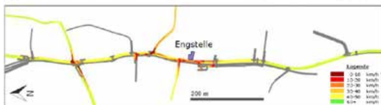
Abb. 2: Die Darstellung zeigt farblich differenziert die mittleren Geschwindigkeiten pro Streckenabschnitt der Simulation mit Einengung und Prognosebelastung. Daraus lässt sich schliessen, dass die Verkehrsqualität an der Engstelle sehr gut ist.
