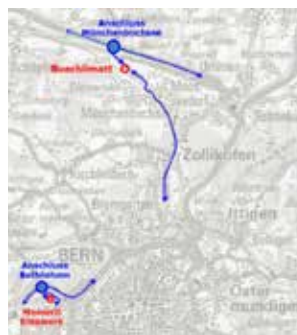
Erschliessung: Übersichtskarte der zu untersuchenden Standorte (rot). Das grobe Erschliessungskonzept ist für beide Standorte blau eingezeichnet.
