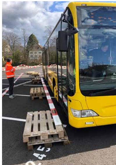
Bild 2: Halteposition für Messung Spaltmass
