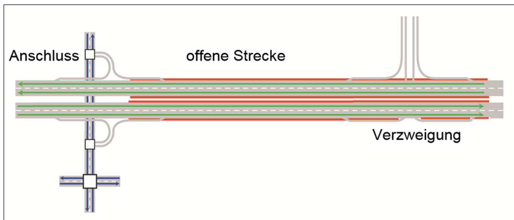
Abb. 5.2 Netzelement „offene Strecke“.
